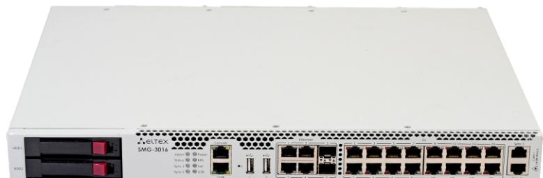
**Гибридная платформа SMG-3016** может использоваться в качестве транкового шлюза для сопряжения сигнальных и медиапотоков TDM- и VoIP-сетей, IP-АТС с поддержкой функций ДВО и СОРМ, а также выступать универсальным решением для построения инфокоммуникационных сетей связи нового поколения. Широкая функциональность, строгое соответствие стандартам и высокая надёжность операторского класса позволяют решать на базе SMG-3016 большинство возникающих у операторов и сервис-провайдеров задач.
